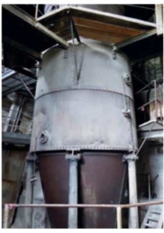
Der Kalk für die Saftreinigung wurde in einem Kalkschachtofen von 1898 gebrannt. Ein Lastenaufzug beförderte Kalksteine und Koks auf die obere Ebene des Ofens und das alles ohne Motorantrieb – mit Hilfe eines Wasserkastens.
