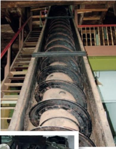
In der Rübenwäsche-Anlage mit großem Hubrad wurden die Zuckerrüben von Schmutz befreit. Die gereinigten Zuckerrüben förderte eine 17 Meter lange Transportschnecke über eine Rübenkippswaage in die Schneidmaschinen, wo sie zu Schnitzeln zerkleinert wurden.
