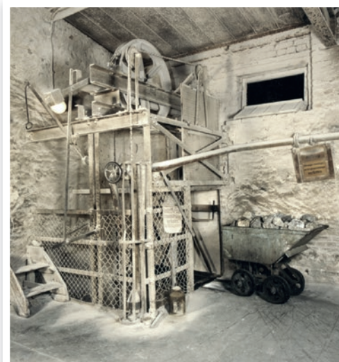
Seilaufzug mit Wasserkasten.
