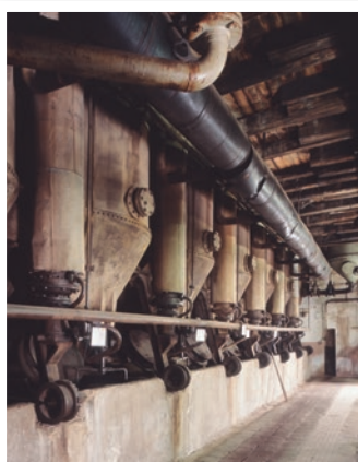
Beim Entleeren des Diffuseurs fallen die entzuckerten Schnitzel in den sogenannten Schnitzelsumpf.
