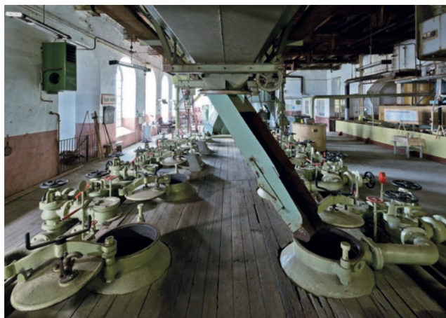
Diffusionsbatterie von 1906: Die Diffusionsgefäße werden mit frischen Rübenschnitzeln befüllt – ein Vorgang, der ca. jede acht Minuten wiederholt wird.
