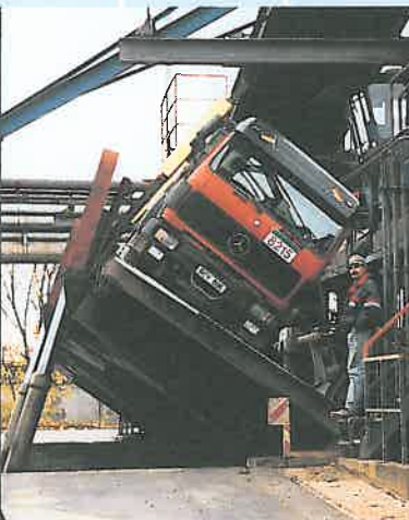
Kippanlage für „Rüben-Lkw“.
